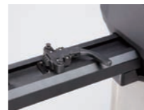
ターンテーブルブレーキ ラケットが動かないように固定できます。
